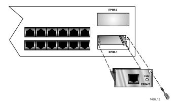
Figure 3-8. Installing an EPIM
